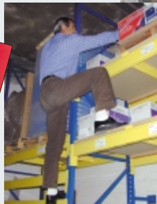
Sur un escabeau ou en équilibre instable sur un rack de stockage, le risque de chute ne doit pas être minimisé
